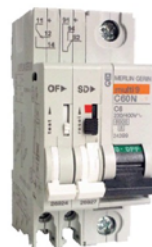
Автомат с блок-контактами. Может использоваться для контроля работоспособности Холодильного оборудования. (Зачастую, при неисправности контуров конденсатора или испарителя выбивает автомат питания).
